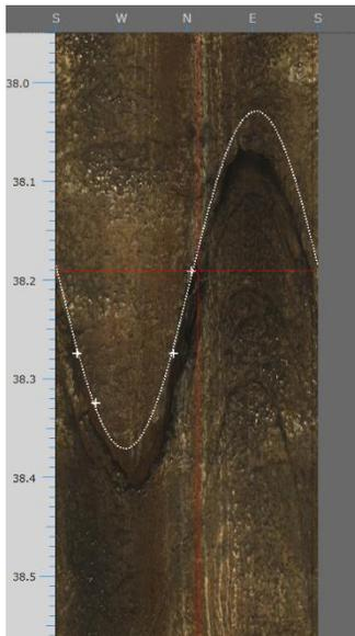
面構造の変曲点をマウスクリックで4点指定する。4点目から計算された面構造の白点線が表示される。
