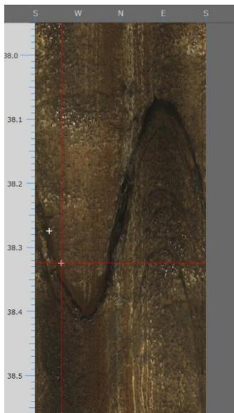
「最小二乗法によるフィッティング入力」を選択すると、孔壁画像上に赤十字線のガイド線が表示される。十字線の中心が指定位置となる。
